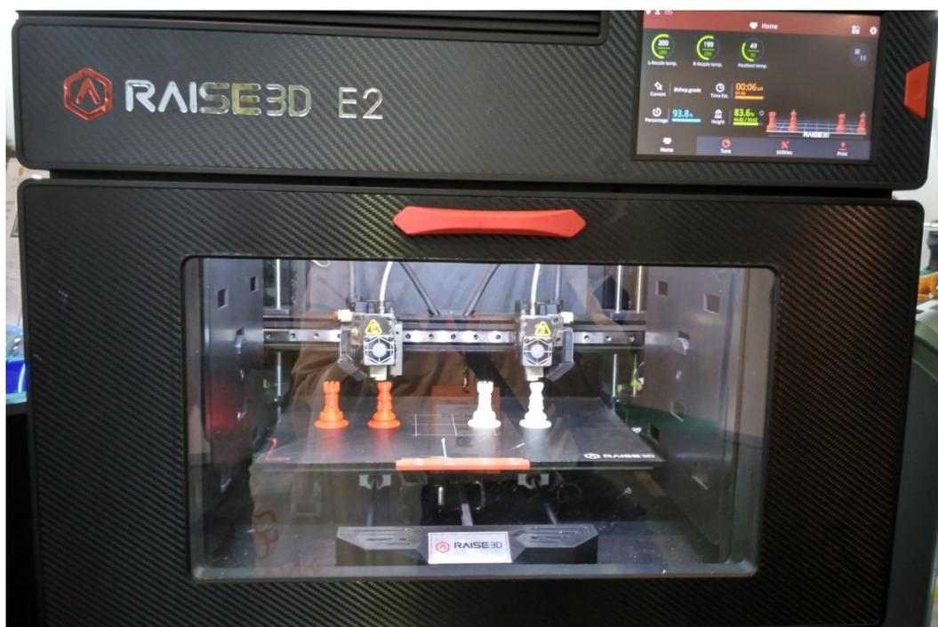
Рис. 3. Принтер Raise3D E2 с двумя независимыми экструдерами в режиме дублирования
