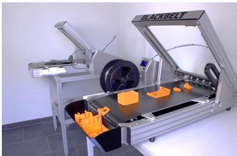
Конвейерный принтер компании Blackbelt3D
