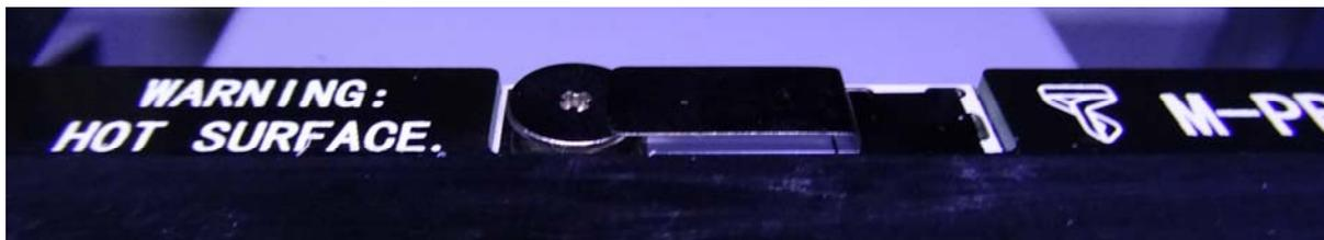
Контакт калибровки на рабочем столе принтера
