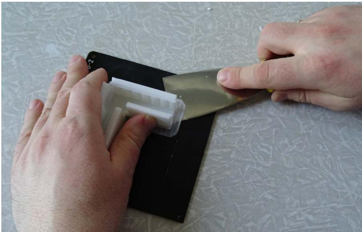
Снятие напечатанной модели с доски при помощи шпателя
