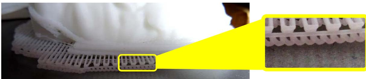
Из-за неправильной калибровки высоты сопла и не прогретого рабочего стола пластик в рафте лег «кренделями»: его прилипание оказалось недостаточным и модель при печати была сорвана с доски
