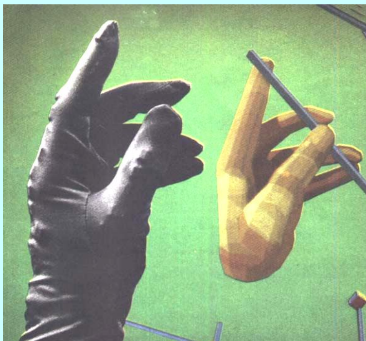
Рис. 1. «Виртуальная перчатка» и ее образ на экране дисплея
