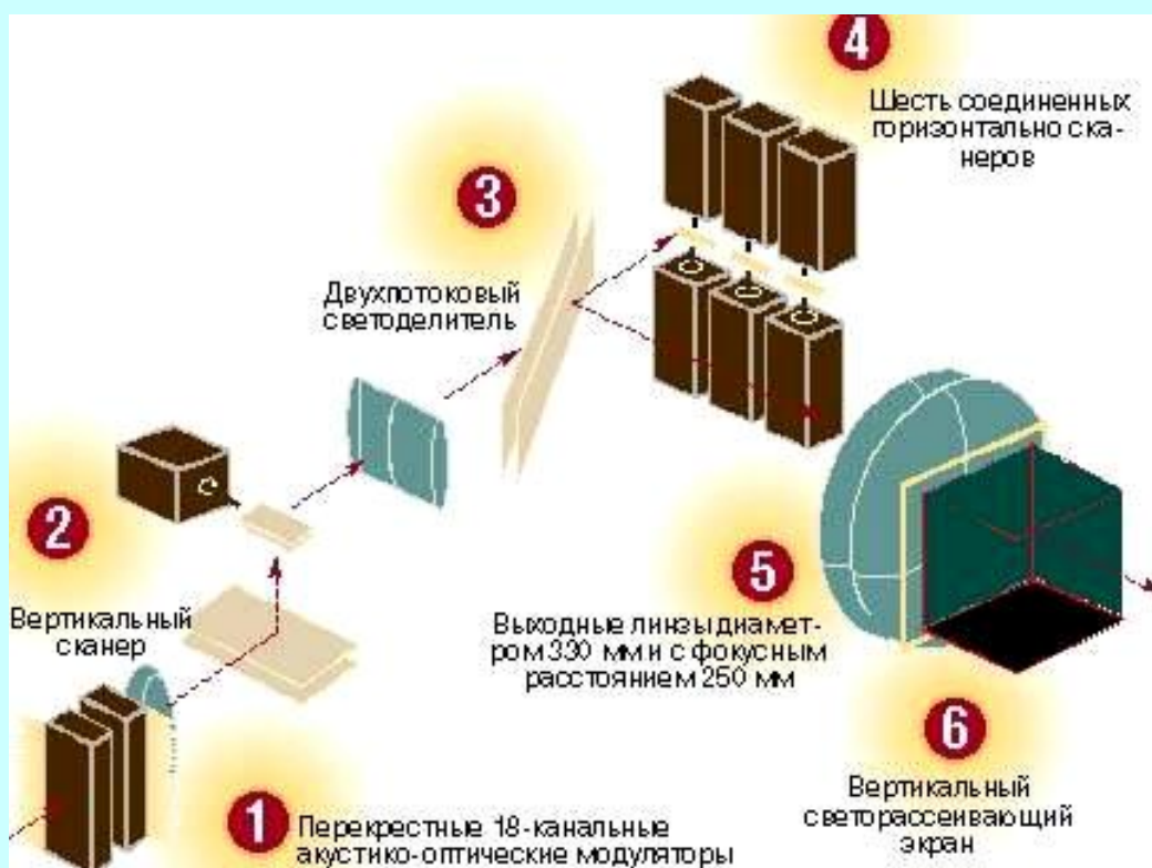
Рис. Схема воспроизведения изображений дисплея Mark-II
