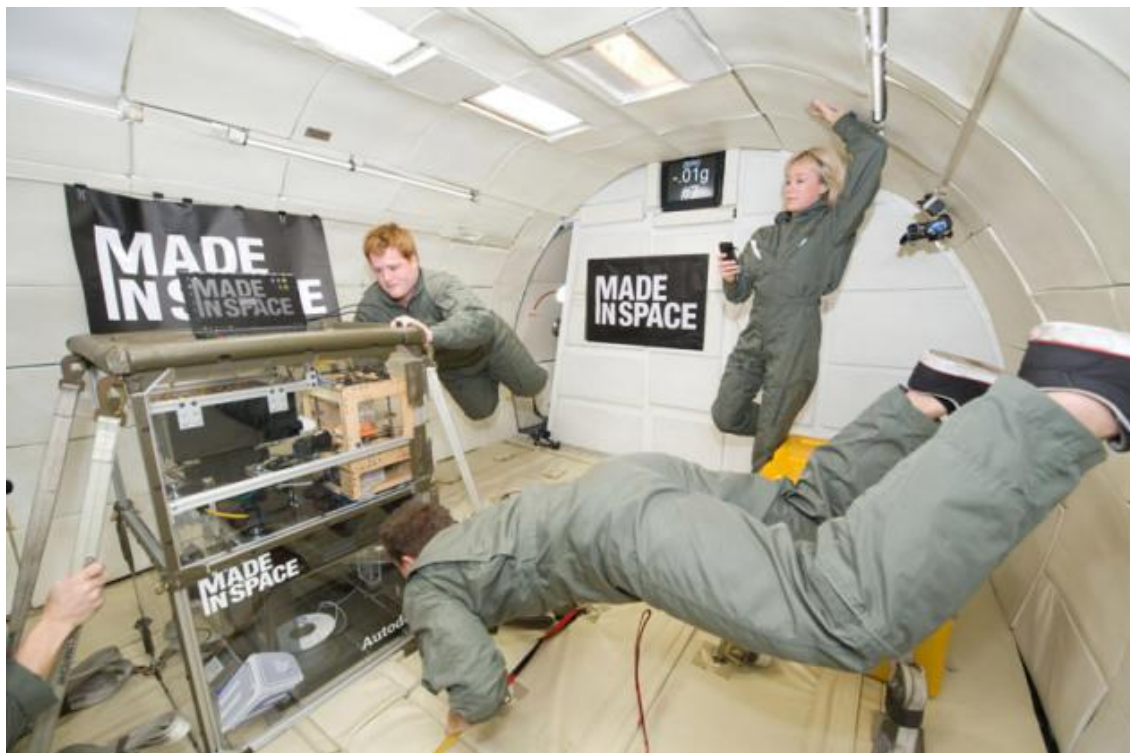
Испытания «космического» 3D-принтера в «искусственной невесомости» на борту самолета (фото НАСА)
